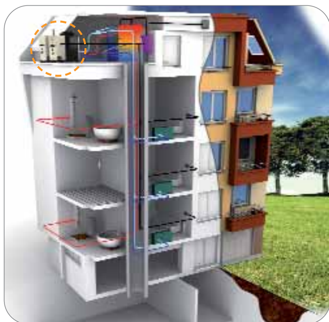
Esempio di applicazione GA-HR con pompa di calore reversibile GAHP-AR in funzionamento estivo per impianto a fancoils e produzione indiretta ACS.
